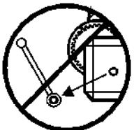
**3.16** - NUNCA desmontar la manivela del cabrestante cuando el elevador está soportando una carga o extendido.
