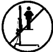
**3.1** - La torre elevadora TE-086 es una máquina diseñada para la elevación de cargas en dirección vertical. NUNCA se debe utilizar como plataforma eleavadora de personas.
