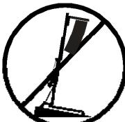
**3.2** - Colocar el elevador sólo en superficies firmes y planas, verificando que está en posición vertical, utilizando el indicador de nivel de burbuja (**L**) que se encuentra en la base. Ajuste los estabilizadores (**Q**) girando las manivelas (**H**) hasta nivelar, si es necesario. Nunca utilice cuñas u otros objetos extraños para equilibrar el elevador.
