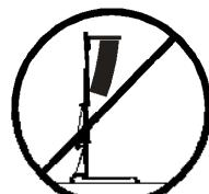
**3.4** - Este elevador NUNCA debe utilizarse para elevar una carga que no ha sido correctamente revisada. Es necesario verificar que la carga está correctamente apoyada y centrada en el soporte de elevación apropiado para que el peso de la carga sólo actúe en una dirección vertical.
