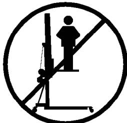
**3.1** - La torre elevadora TE-071 es una máquina diseñada para la elevación de cargas en dirección vertical. NUNCA se debe utilizar como plataforma eleavadora de personas.
