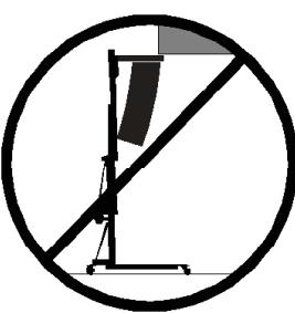
**3.10** - Tenga cuidado con todos los obstáculos por encima de la elevación y su zona de extensión, como cornisas, balcones, letreros luminosos, etc. Es muy importante evitar la presencia de todo tipo de cables por debajo de la torre extendida.
