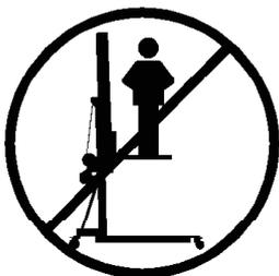
**3.1** - La torre elevadora TE-064 es una máquina diseñada para la elevación de cargas en dirección vertical. **NUNCA** se debe utilizar como plataforma elevadora de personas.
