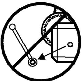
**3.16** - NUNCA desmontar la manivela del cabestrante cuando el elevador está soportando una carga o extendido.
