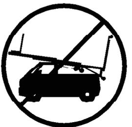
**3.13** - Antes de transportar la torre, todos los tramos deben ser bajados, y las patas deben extraerse y colocarse en su posición de transporte.
