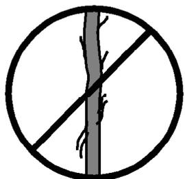
**3.12** - Antes de utilizar el elevador, compruebe el estado del cable. El cable no debe contener hilos rotos o mostrar signos de áreas aplastadas/aplanadas.
