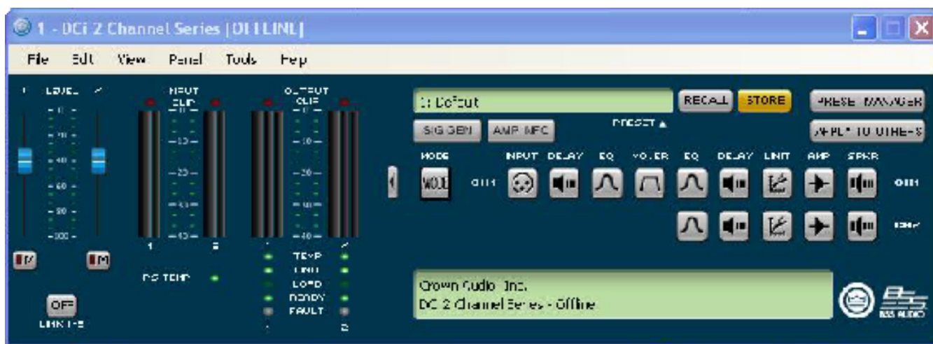
图 16 选中“Y 1+2”框时，输出 Ch.1 和 Ch.2 均由输入 Ch.1 馈送，而输入处理也照此安排。
